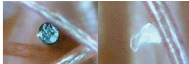
アクリル繊維に付着した柔軟剤の香料カプセル デジタル顕微鏡で1000倍+画像処理したもの 丸い粒の中にさらに小さい粒々が見える
